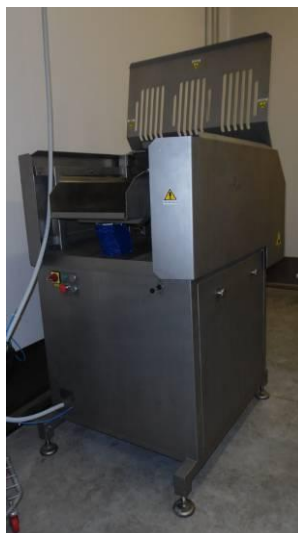
Esempio di ghigliottina, simile a quella prevista. In primo piano lo scivolo di alimentazione
